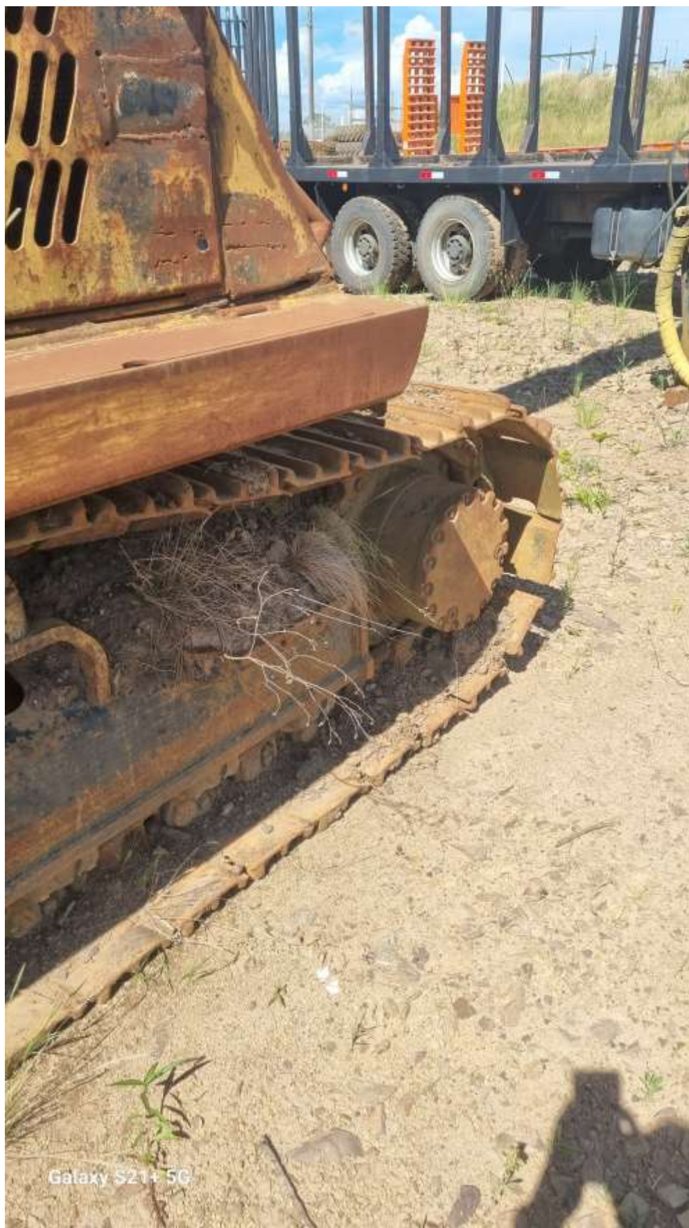
FOTO 10 – VISTA MOSTRANDO O ESTADO DO CONJUNTO RODANTE
