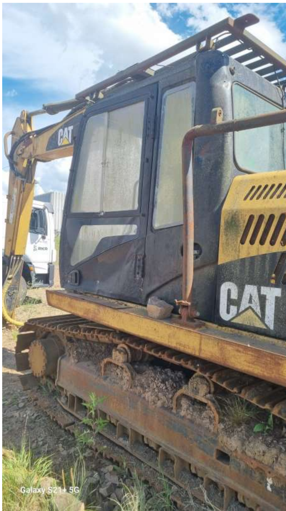
FOTO 11 – VISTA DO ESTADO DO RODANTE, DA CABINE, DA LANÇA E DOS BRAÇOS OXIDADOS .
