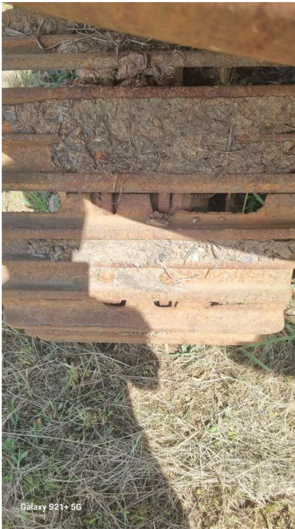
FOTO 6 – FOTO DA ESTEIRA COM ELOS QUEBRADOS
